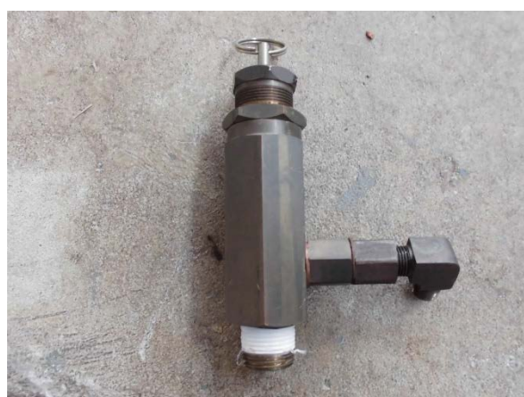
写真 2.1.9-1 空気圧縮機No.1 と交換した圧力調整弁
