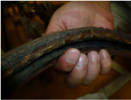
パッキンの劣化状況
